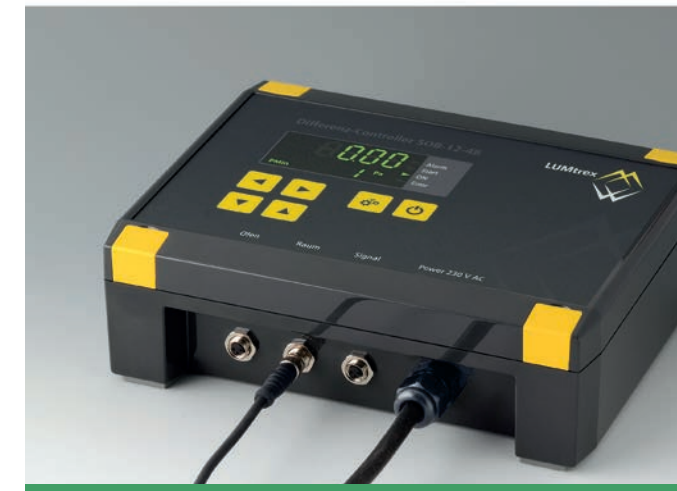
Konturbündige Designblenden für verdeckten Verschraubungsbereich (hier in Sonderfarbe)
